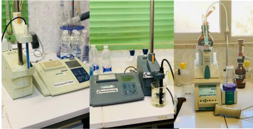
شكل (2) يوضح بعض الأجهزة المستخدمة في تحليل عينات الماء
